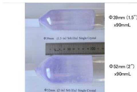
Figure 1 SrI<sub>2</sub>(Eu) 1.5”, 2” Single Crystals
