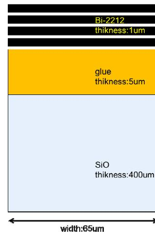
図1 数値計算に用いた構造モデル
