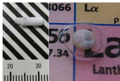
図1. 育成した結晶の写真(左), 育成方向に垂直に1mm厚に切断研磨したサンプルの写真(右)。
