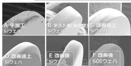
図1 ウェハ端部形状の推移 (FE-SEM 写真)
