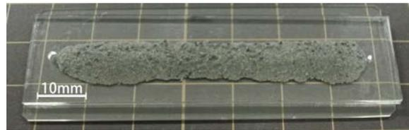
Fig.2 磁性粒子流路チップ
