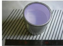
図 2. 封缶した 2 インチ径  $\text{SrI}_2(\text{Eu})$  単結晶
