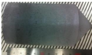
図 1. 2 インチ径  $\text{SrI}_2(\text{Eu})$  単結晶
