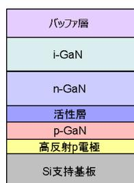
図 1 成長基板除去後の試料の模式図
