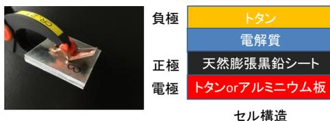
図1 試作した金属空気電池の外観とセル構造
