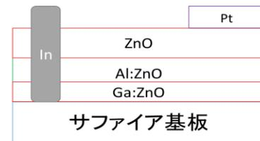
図2：試料構造 bufferZnO 10nm/Ga:ZnO 0.5 μm/Al:ZnO 2 μm/ZnO 1 μm
