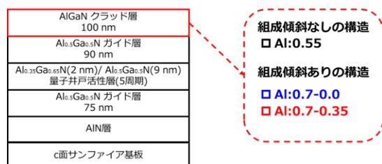
図 1 試料の構造図
