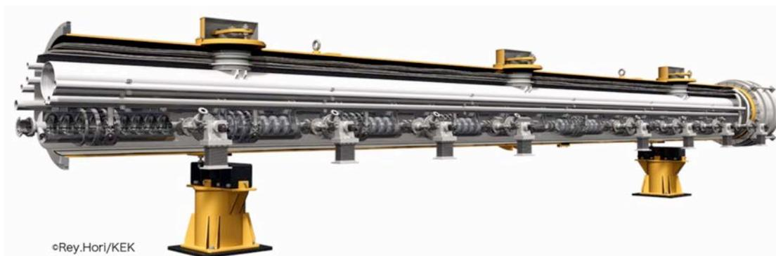
図 1 クライオモジュールのカット図。円筒容器の下部に 9 台の超伝導加速空洞が設置される。超伝導加速空洞のまわりのヘリウム容器内には液体ヘリウムが充填され、2K に冷却され、空洞は超伝導状態で運転される。
