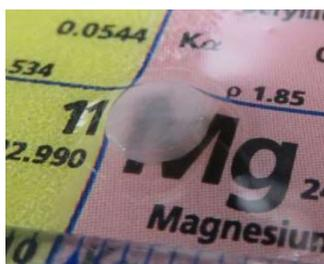
図1.育成した共晶体を、育成方向に垂直に1mm厚に切断研磨したサンプルの写真
