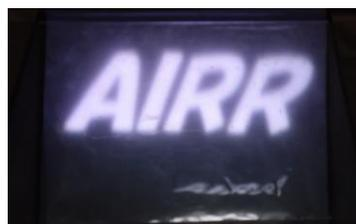
図 3. プロジェクターを用いた AIRR による空中像。
