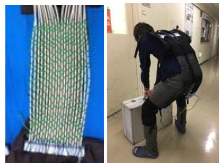
図3 細径人工筋製の布とスーツ
