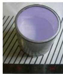
図 2. E:SrI<sub>2</sub> バルク単結晶
