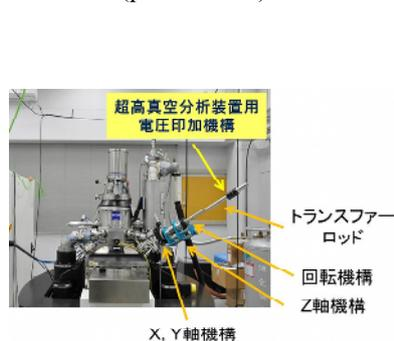
Fig. 1 電圧印加機構を設置したHIM装置
