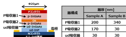
図1：素子断面図および層構成
