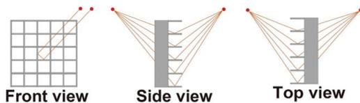
図2 WARMによる熱収束の原理.
