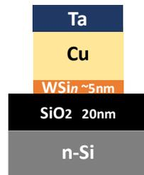
図 1. Cu/ $WSi_n$ / $SiO_2/Si$  の MOS キャパシタの断面模式図
