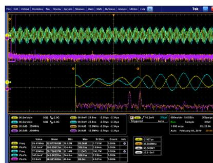
図 2: 633 nm と 543 nm レーザーのビート信号
