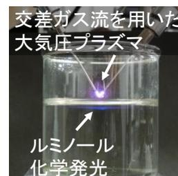
図3 交差ガス流を用いた大気圧グロー放電によって誘起されるルミノール化学発光
