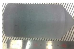
図1. 2インチ径  $\text{SrI}_2(\text{Eu})$  単結晶
