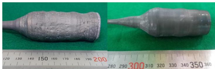
図 1 CZ 法で作製した 1 インチ $\phi$  Fe-Ga インゴット
