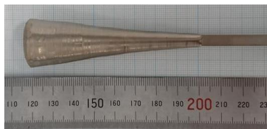
図 2 抵抗加熱炉型 CZ 法で作製した最大径 1 インチ $\phi$  の Ga 濃度約 25 at% Fe-Ga インゴット
