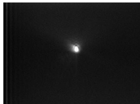
図 2 直線導波路への電流 150mA 注入時の近視野像
