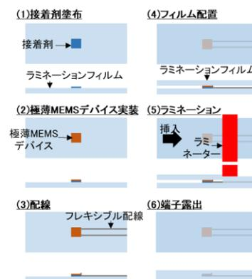
図 1. ラミネーション技術を用いた極薄 MEMS デバイス封止プロセス
