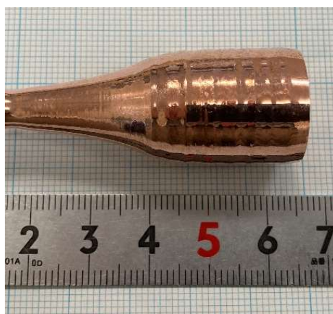
図 1 \phi 18 \text{ mm} \times \text{直胴 } 25 \text{ mm} の作製した Cu 単結晶
