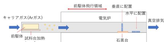
図 1. 管状炉を用いた熱 CVD 装置の模式図
