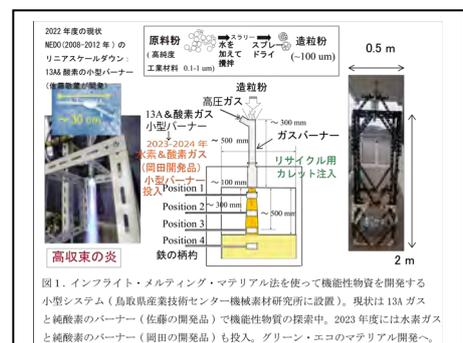
図1. インフライト・メルティング・マテリアル法を使って機能性物質を開発する小型システム(鳥取県産業技術センター機械素材研究所に設置)。現状は13Aガスと純酸素のバーナー(佐藤の開発品)で機能性物質の探索中。2023年度には水素ガスと純酸素のバーナー(岡田の開発品)も投入、グリーン・エコのマテリアル開発へ。
