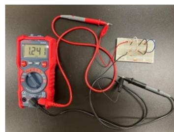
図2 マルチメータによる測定結果。表示は、 $1.241\text{k}\Omega$ を示している。
