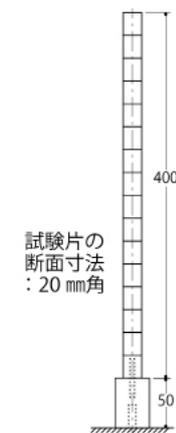
図4 振動試験片
