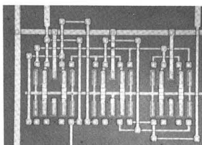
FIGURE.2 Edge trigger T-FF
