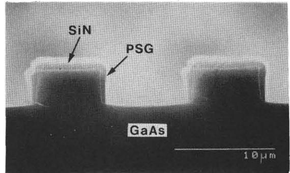
(d) Reactive ion etching of PSG
