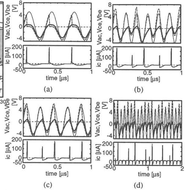
Fig. 5. Simulated waveforms of  $v_{ac}$ ,  $v_{ce}$ ,  $v_{be}$  and  $i_c$ . (a)  $f = 3\text{ MHz}$  (period 1) (b)  $4.8\text{ MHz}$  (period 2) (c)  $5.6\text{ MHz}$  (period 4) (d)  $10\text{ MHz}$  (chaos).
