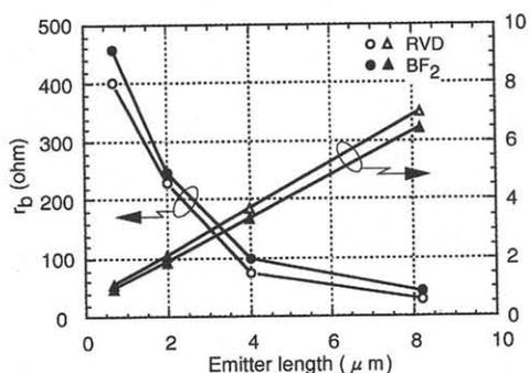
Fig. 8  $r_b, C_{TC}$  vs.  $L_E$
