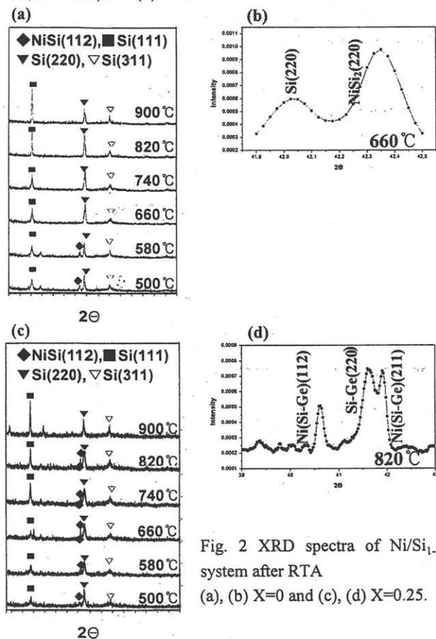
Fig. 2 XRD spectra of  $Ni/Si_{1-x}Ge_x$  system after RTA (a), (b)  $X=0$  and (c), (d)  $X=0.25$ .
