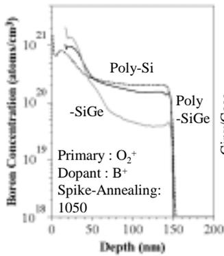
Fig. 5. SIMS-Profile of B-diffusion in poly-SiGe, -SiGe and poly-Si.
