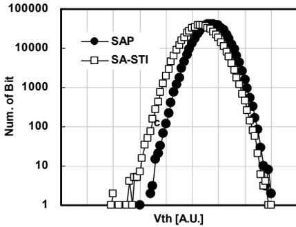
**Fig. 3.** Erase  $V_{th}$  dispersion
