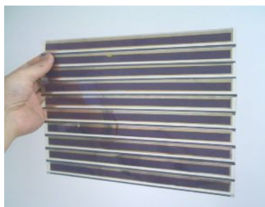
Fig. 4 Full-plastic DSC module (27 x 20 cm, 60 g).
