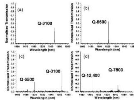
**Fig. 2** Measurement result for extended cavity for (a) 2  $\mu\text{m}$  (b) 2.5  $\mu\text{m}$  (c) 3  $\mu\text{m}$  (d) 3.5  $\mu\text{m}$
