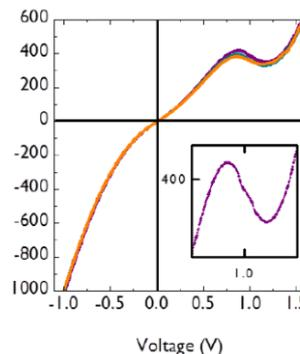
Fig. 3 I-V in p<sup>+</sup> MoS<sub>2</sub>/n<sup>+</sup> GaN tunnel diode [12]
