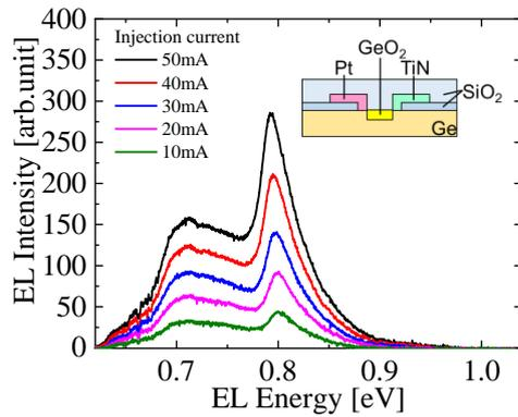
Fig. 2 EL spectra for bulk Ge diodes.
