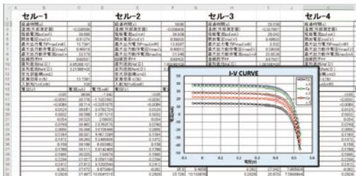
I-V測定データは、Excelシートに入力され、同時に作図されますから、目視で容易に判定が可能です。事前にパラメータの判定値を入力しておくと、NG値がシートに赤色で入力されます。測定を自動モードに設定すると、各セルごとに測定条件が自動的に設定され測定が行われます。測定時間は若干長くなります。
