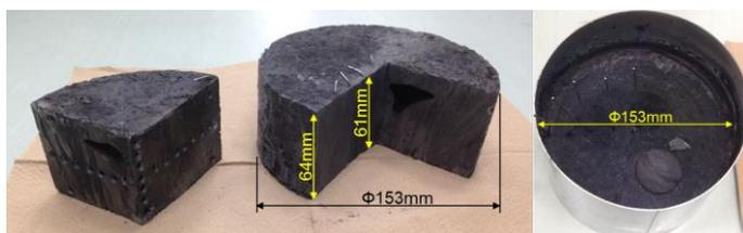
図1 合成した切断後の4N鉛リチウム合金及び5N鉛リチウム合金
