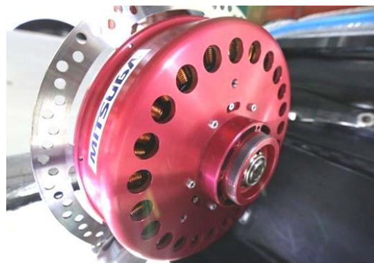
図6 高効率ダイレクトドライブモータ
