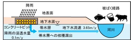
図 1 ①地下水面上位設置モデルの概念図
