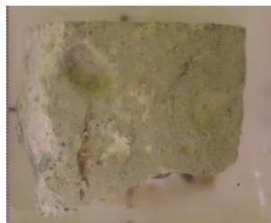
図1 1号機原子炉建屋1階で採取されたコンクリート片 (3RB-AS-R9-1) の外観 (左) とオートラジオグラフィ像 (右) の例
