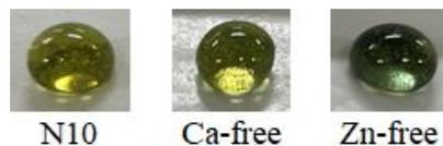
Fig.1 Ar ガス掃気で作製した U 含有ガラス
