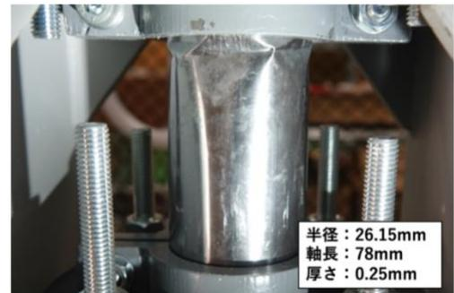
図1 水平振動荷重による座屈
