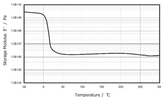
Fig. 6 DMS Curves of Stretchable Epoxy Film
