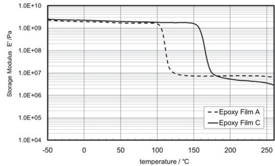
Fig. 2 DMS Curves of High Flexible Epoxy Film
