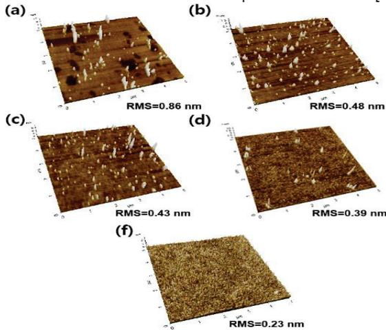
**Fig. 5 Surface morphology of (a) HfO<sub>x</sub>, (b) Hf:Al=3:1, (c) Hf:Al=1:1, (d) Hf:Al=1:3 and (e) AlO<sub>x</sub> films**
