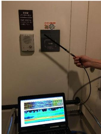
図8 実際の測定場面 院内居室への入退出管理システムのRFID(μチップ)リーダーへプローブアンテナを近づけた様子
