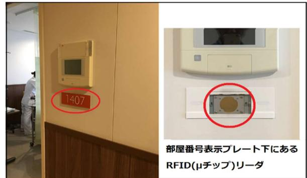
図6 測定結果 廊下表示灯RFID( $\mu$ チップ)リーダーとプローブアンテナとの距離0.05m
